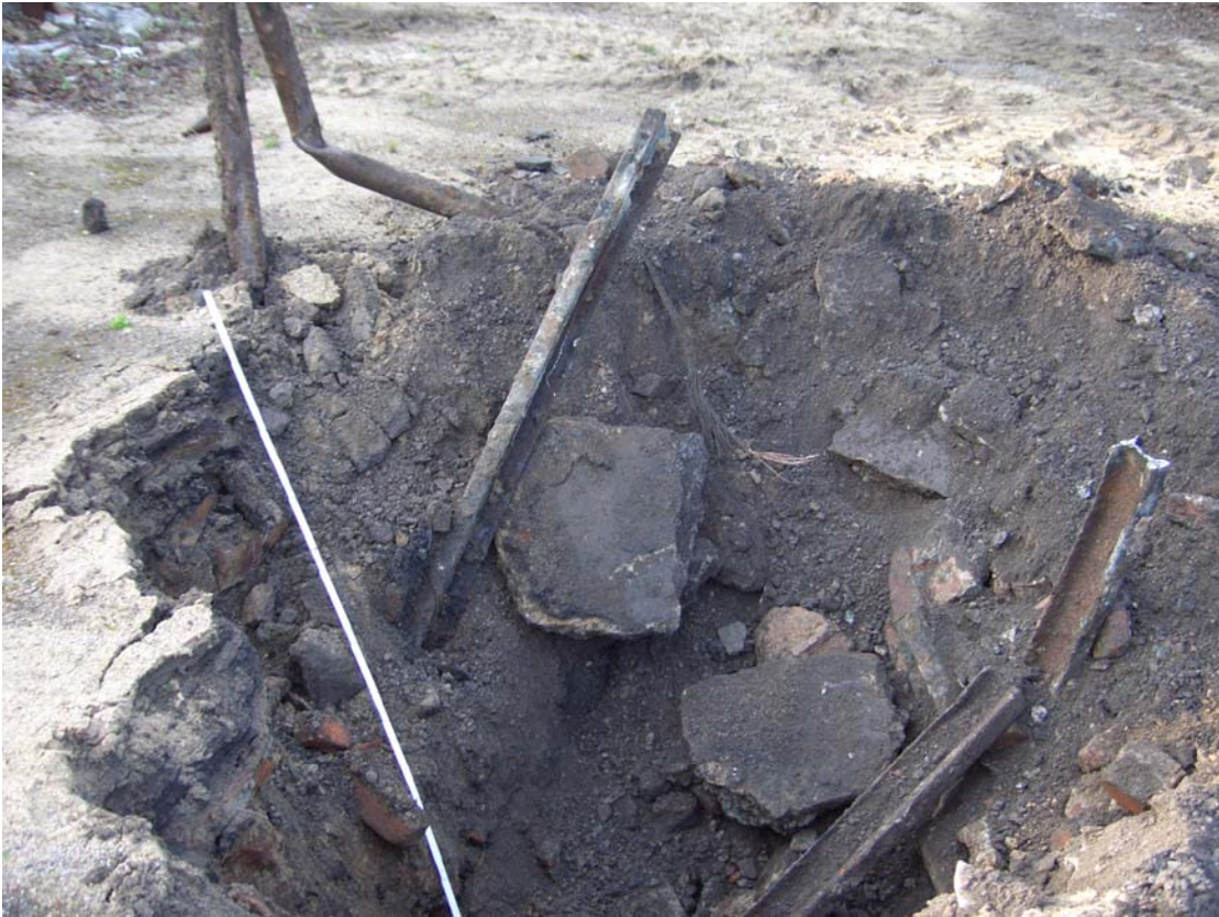
Auffüllung mit grobem Bauschutt, Schienen, Kabelresten und Rohrstücken
